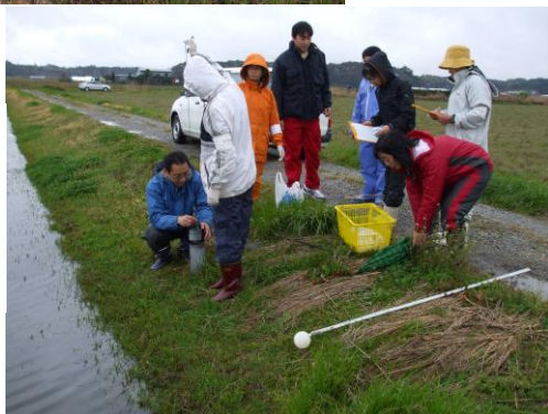
図2. 水田脇の観測井にて地下水採取。
