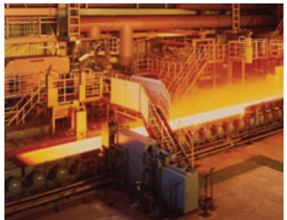
第3熱間圧延工場の様子である。多量の工業用水を用いて、鉄を引き延ばしている。使用した水の約90%は回収し、再利用している。
