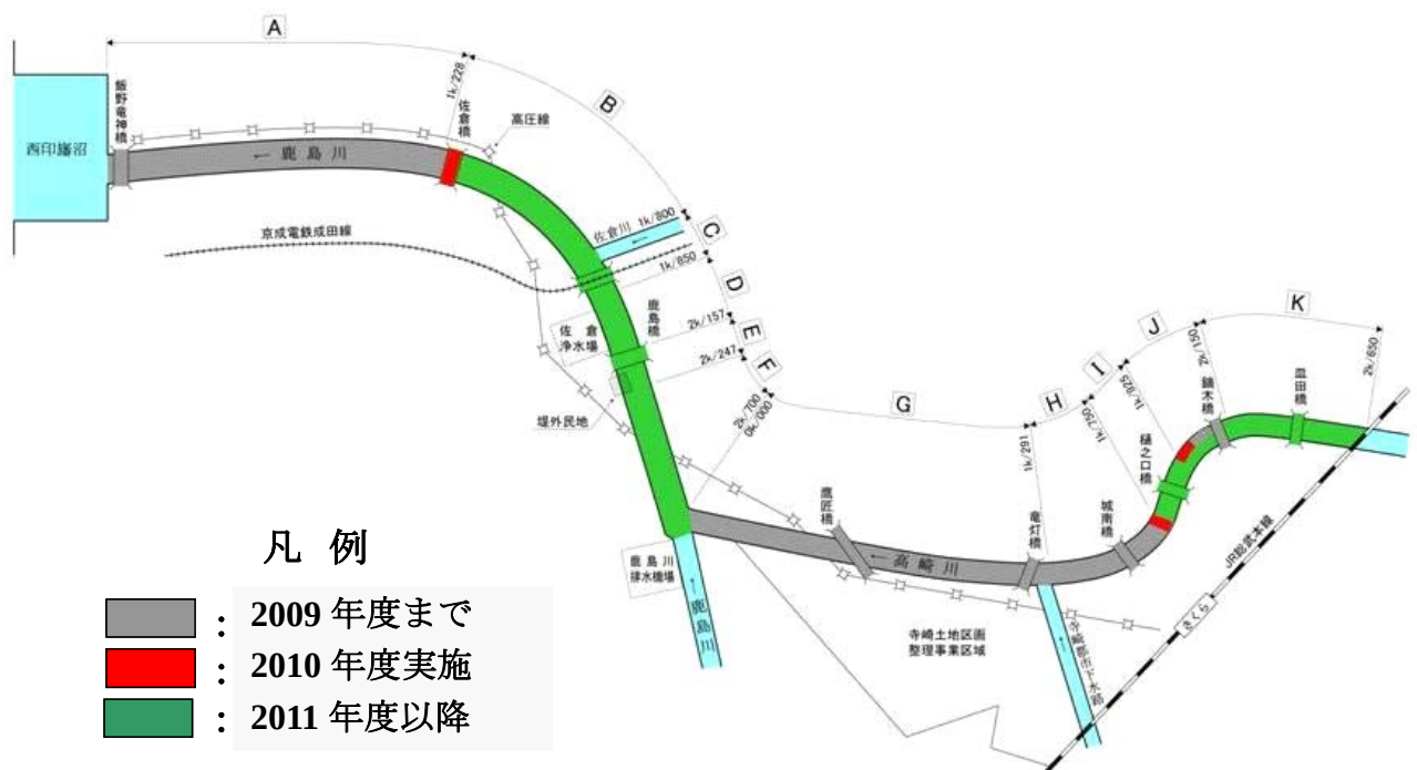
図 45 鹿島川・高崎川の河道整備状況
