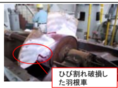
甚兵衛、埜原機場ポンプ破損状況
