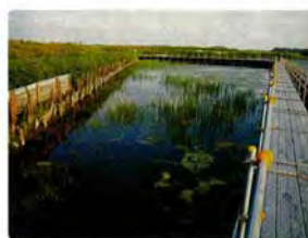
↑印旛沼の実験施設。岸から1500mを鋼板で囲い、冬の間にへどろの除去と減水を実施。春にはさっそく発芽が確認された。
