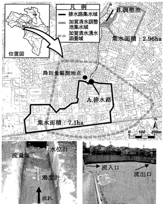
A.排水路調査 調査状況 B.調整池調査 調査状況
